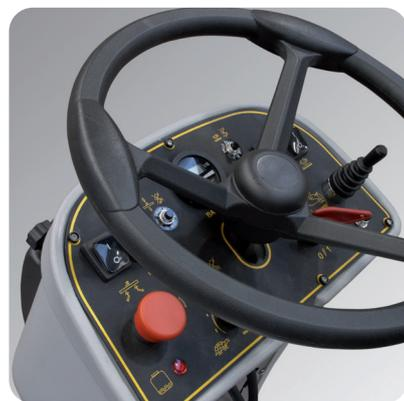
d'aspiration. Les autolaveuses Comfort M sont faciles à utiliser grâce aux commandes simples et intuitives. Du tableau de contrôle, l'opérateur peut régler la vitesse maximale et la quantité de solution détergente, en sélectionnant l'option la plus adaptée pour chaque type de saleté. Le travail est simplifié et rendu plus rapide
