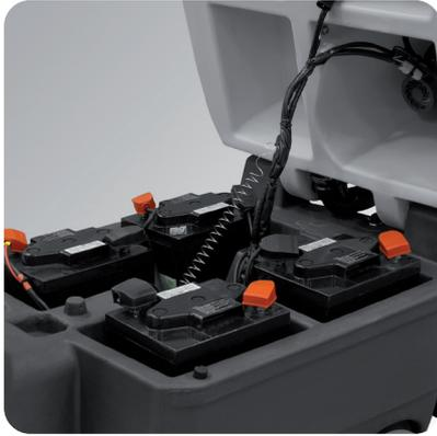
Le réservoir de récupération permet également le logement de batteries de grande capacité et un temps d'utilisation ou d'autonomie pouvant aller de 4 à 5 heures. Les réservoirs en polyéthylène haute résistance aux chocs et aux produits à pH acides sont de grandes contenances (110 l /135-150l) évitant les arrêts pour le remplissage ou le vidage.
