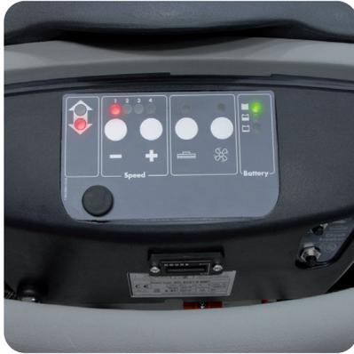
Tableau de commande analogique, simple et intuitif. Sélecteur de réglage de la vitesse. Interrupteur général ON/OFF et interrupteur à clé, interrupteur pour le moteur de la brosse et d'aspiration. Disjoncteur thermique pour protéger le moteur des brosses et d'aspiration, indicateur
