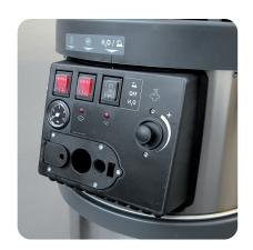
Nouveau panneau de commande simple et intuitif, pistolet à vapeur à accouplement rapide, interrupteur principal ON/OFF avec témoin lumineux, interrupteur ON/OFF de chaudière avec témoin lumineux, régulateur/sélecteur de vapeur/détergent, régulateur de débit de vapeur, témoin lumineux vapeur prête, témoin lumineux de bas niveau d'eau avec buzzer, manomètre de vapeur. Pistolet avec interrupteur ON/OFF d'aspiration (modèle GV etna-R 5.1)
