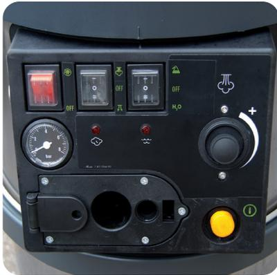
Nouveau panneau de commande simple et intuitif, pistolet à vapeur à accouplement rapide, interrupteur principal ON/OFF avec témoin lumineux, interrupteur ON/OFF de chaudière avec témoin lumineux, sélecteur de fonction air comprimé/vapeur, sélecteur eau/détergent, régulateur de débit de vapeur, témoin lumineux vapeur prête, témoin lumineux de bas niveau d'eau avec buzzer, manomètre de vapeur et manomètre air. Pistolet avec interrupteur ON/OFF d'aspiration et affichage du niveau de puissance.
